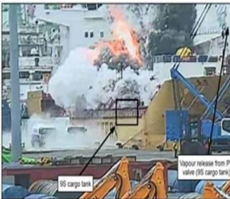
Ruptura del tanque e ignición del vapor liberado - Imagen: MAIB
